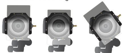
Pour positionner la ligne du dégradé, glissez le filtre de haut en bas dans le porte-filtres.
